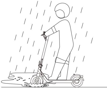
**⚠️** Fahren Sie nicht schneller als 10 km/h über Drehel, Schwelben oder andere unebene Flächen. Leichtes in die Knie gehen fängt den Aufprall zusätzlich ab. fängt den Aufprall zusätzlich ab.
