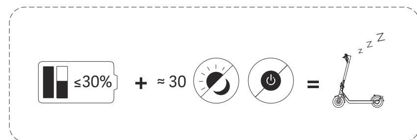
Wenn der Roller etwa einen Monat lang ausgeschaltet ist und die Ladung des Akkus weniger als 30 % beträgt, geht der Roller in den Schlafmodus über. Wenn dies geschieht, kann der Roller nicht eingeschaltet werden. Um den Schlafmodus zu beenden, laden Sie den Roller für etwa drei Sekunden auf, um den Akku zu aktivieren.
